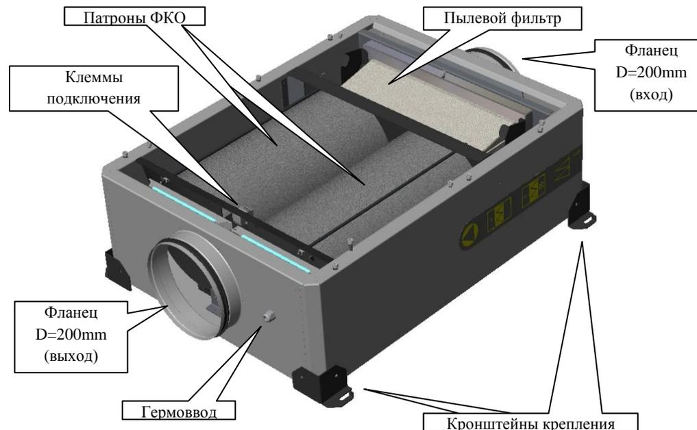
**Внимание!** Фильтр фотокаталитический монтируется после приточной вентиляционной установки, т.е. в него должен поступать воздух с температурой не ниже +5°C.
